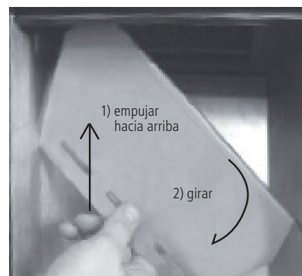
Fig. 17: extracción de la placa cortafuego
