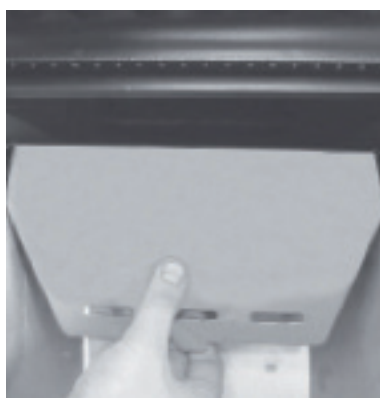
Fig. 16: rotación de la placa cortafuego
