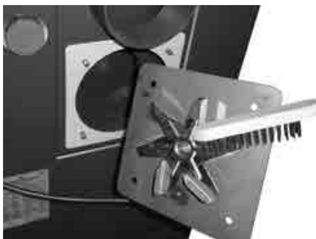
Ukázka čištění oběžného kola a kontrola lopatek odtahového ventilátoru (mimo D10PX)
