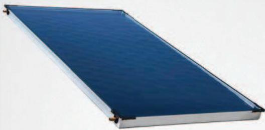
Plochý kolektor určený k vertikální i horizontální montáži nad střešní krytinu. Lyrový absorbér s vysoko selektivním povrchem TiNOx je spojen s měděným potrubím technologií laserového svařování. Izolaci tvoří 40mm vrstva minerální vlny. Připojení je umístěno nahore a dole po stranách.
