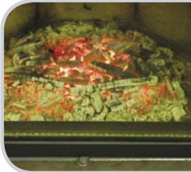
Je dosaženo, když je dřevo zcela spáleno, a nemůže vzniknout nízkotepelné hoření nebo nedokonalé spalování. Nyní může být regulační páčka uzavřena. (levá poloha)
